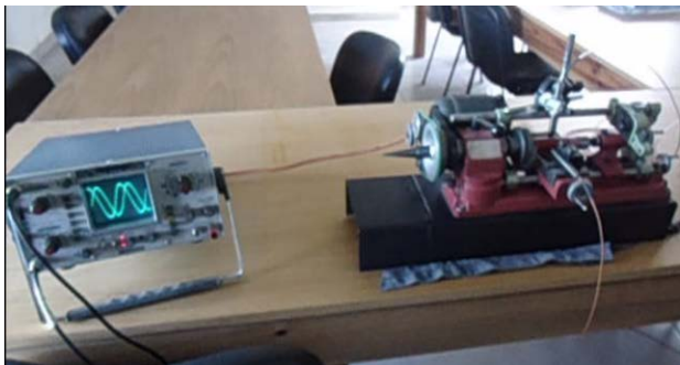
Fig. 9a. Modelo didáctico para análisis de órbitas en máquinas
