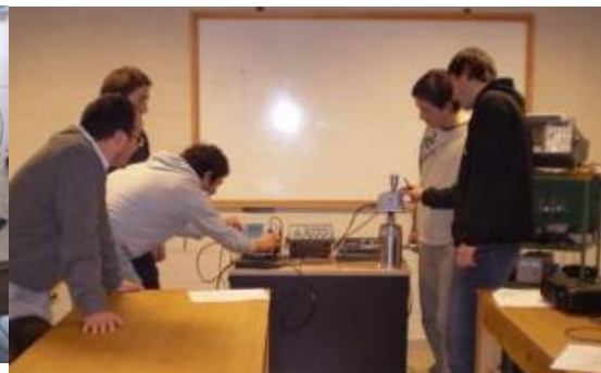
Fig. 9b Estudiantes realizando calibración de un transductor de velocidad vibratoria
