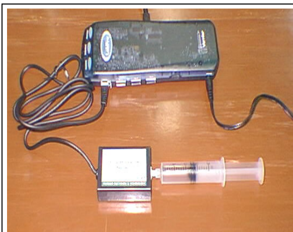
Figura 1. Arreglo experimental para determinar la variación de presión del aire encerrado en una jeringa en función de la variación de volumen. Jeringa ligada al sensor de presión conectado a la interfaz.
