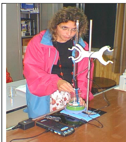
Figura 3. Diseño experimental para determinar la titulación de una solución ácida con una solución base. Vaso de precipitado que contiene la solución ácida sobre un agitador magnético, bureta que contiene la solución base y sensor de pH conectado a la interfaz y computadora.
