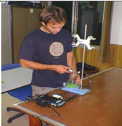
Figura 1. Arreglo experimental para medición de conductividad de una solución de NaCl a medida que se agregan gotas de soluto, con agitación permanente.
