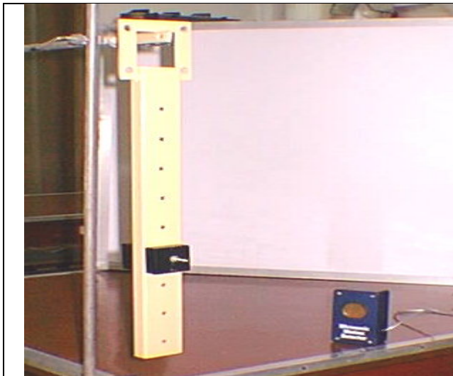
Figura 1. Fotografía del péndulo compuesto construido de acuerdo con el diseño estipulado, el cual puede oscilar alrededor de un eje.
