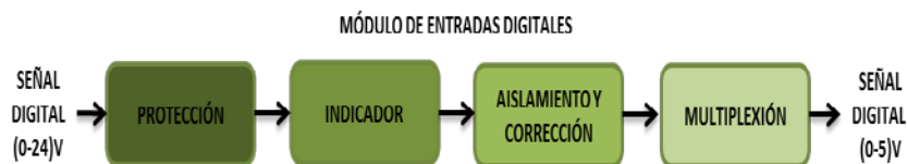
Figura 4: Acondicionamiento para la señal digital de entrada.
