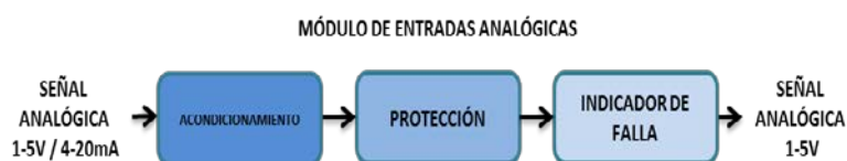
Figura 2: Diagrama de bloques de las etapas del acondicionamiento para las señales analógicas de entrada.
