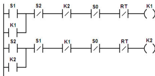
Figura 6- Inversão do sentido de rotação do Motor de Indução Trifásico em Ladder
