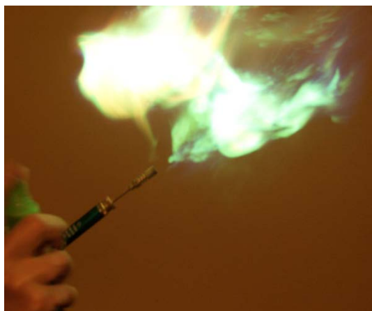
Figura 2. Llama de un soplete al asperjar una solución de cobre
